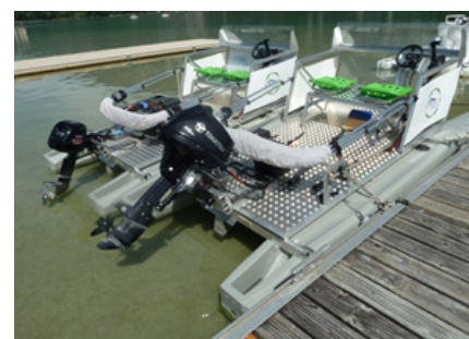
moteur électrique (le plus petit) à gauche de la photo et moteur thermique à droite.
